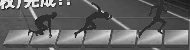
フォースプレートで走力を計測する場合、これまで競技者がプレートの位置を気に掛ける必要がありました。50m走行路に設置した50枚のフォースプレートをCPU処理で1台として計測することにより、いつも通りの走行計測を可能にしました。これにより、現実的に詳細なデータを取得できます。
